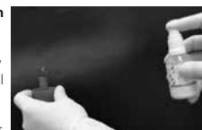
Ryst sprayflasken grundig før bruk. Spray kun én gang (1x) på den interne/eksterne overflate av voksmodellen. Hold en avstand på 15 cm for å få den optimale fordeling av sprayen. Overskuddsmateriale kan fjernes med luftspray.
