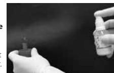
Spray kun én gang (1x) på den interne/eksterne overflade af voksmoden. Hold en afstand på 15 cm for at få den optimale fordeling af sprayeren. Overskydende materiale kan fjernes med luftspray.
