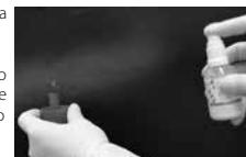
Spruzzare una sola volta (1x) sulla superficie interna/esterna del modello in cera. Mantenere una distanza di 15 cm per disperdere in modo ottimale lo spray. Il prodotto spruzzato in eccesso può essere rimosso con getto d'aria.
