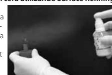
Agitar el bote de spray antes de usar. Rocíe solo una vez (1x) en la parte interna/externa del patrón de cera. Mantenga una distancia de 15 cm para la óptima dispersión del spray. El exceso de humedad puede retirarse con aire a presión.
